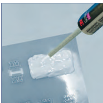
Zabezpieczanie układów scalonych przed ingerencją osób niepowołanych.
