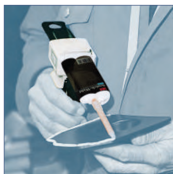
Przyklejanie elementów do tablicy rozdzielczej samochodu.
