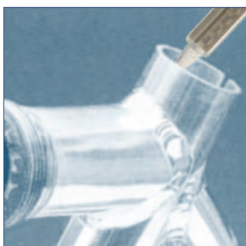
Klejenie elementów ram rowerowych (połączenie rurowe).
