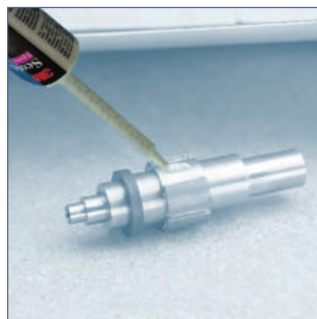
Klejenie magnesów do stalowych wirników.
